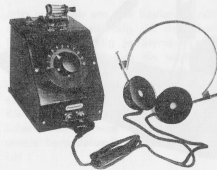
Bild 1. Womit man 1924 den Rundfunk geröh (Detektorempfänger TELEFUNKEN A mit aufgesetztem Kristalldetektor und angeschlossenem Fernhörer)
